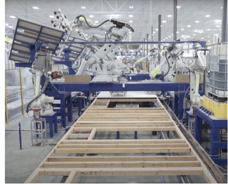
Production automatisée Source : Autovol, Volumetric Modular
